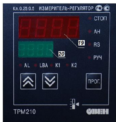
Рис. 5. Лицевая панель измерителя-регулятора TPM210.
